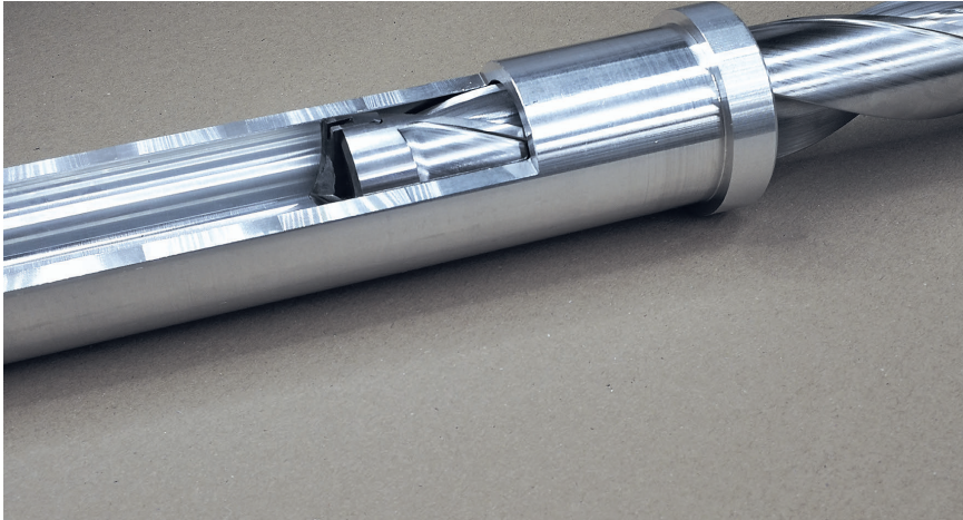
2 Dem Feindreihen vorangestellt ist das Bohren mit dem Wechselkopf-Bohrsystem Sumocham 12 x D von Iscar © Iscar
