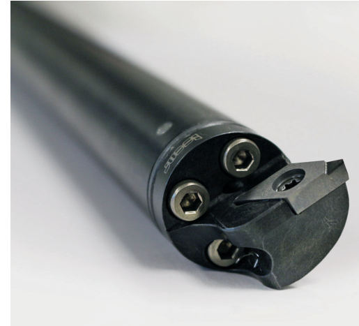
3 Gut erkennbar ist hier, dass die Whisperline-Bohrmaschine bei der Medifa-Lösung mit einem Adapterkopf und einer ISO-Wendeschneidplatte bestückt ist © Iscar
