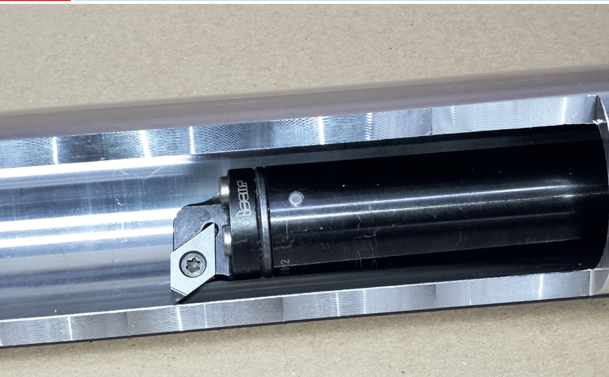
1 Das Feindreihen mit einer Whisperline-Bohrstange von Iscar ist bei Medifa der zweite und letzte Prozessschritt zum Erzeugen 320 mm langer 40-mm-Bohrungen mit R_a = 8 \mu\text{m} in Alu-Zylindern
